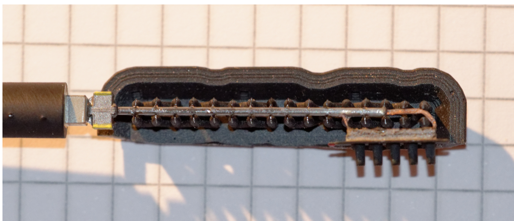
Obr. 7 - Návěstidlo umístěné do přípravku pro montáž servisních stupaček.
