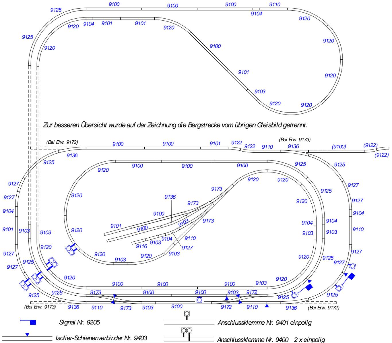
Die Weichen des Überholgleises/Abstellgleises können durch Entfernen der äusseren Drahtbrücken in zweiseitig wirkende Stop-Weichen verwandelt werden. Dadurch können Loks nach Umstellen der Weichen stromlos abgestellt werden.
