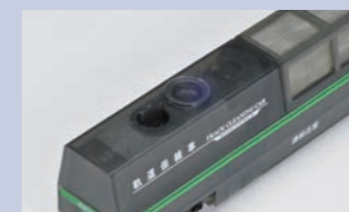
◀ Das Schienenreinigungsfahrzeug hat einen eingebauten Tank, um Reinigungsflüssigkeit zu sparen
