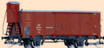
Kleines Bremserhaus, mit Endfeldverstärkung
