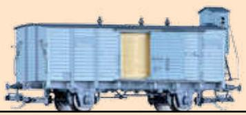
Wärmeschutzwagen, kleines Bremserhaus, ohne Endfeldverstärkung
