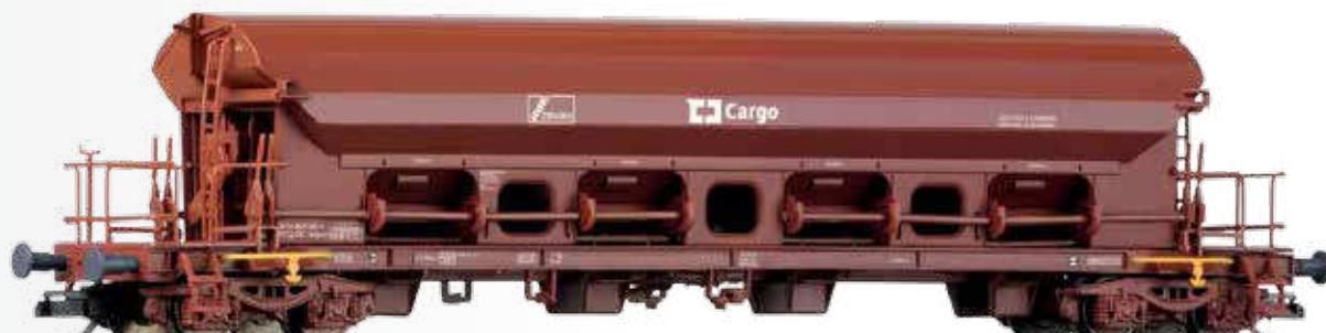
Schwenkdachwagen Tadgnss der CD Cargo
