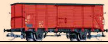
Ohne Bremserhaus, ohne Bremserbühne, mit Endfeldverstärkung
