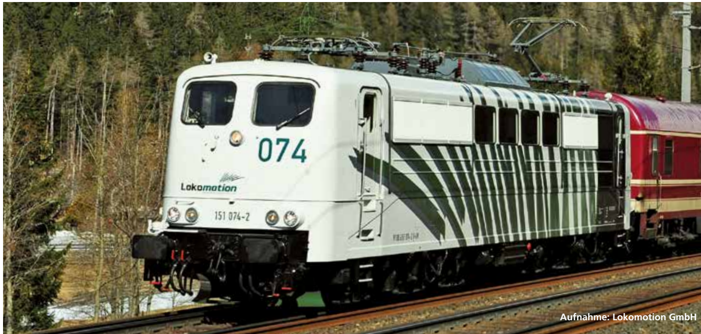
47206 E-Lok BR 151 Lokomotion Ep. VI mit Einholm-Stromabnehmer
