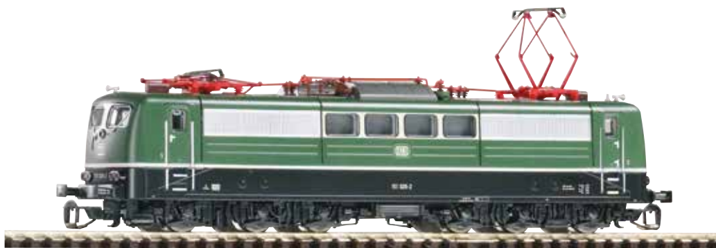
47201 E-Lok BR 151 DB Ep. IV mit Scheren-Stromabnehmer
