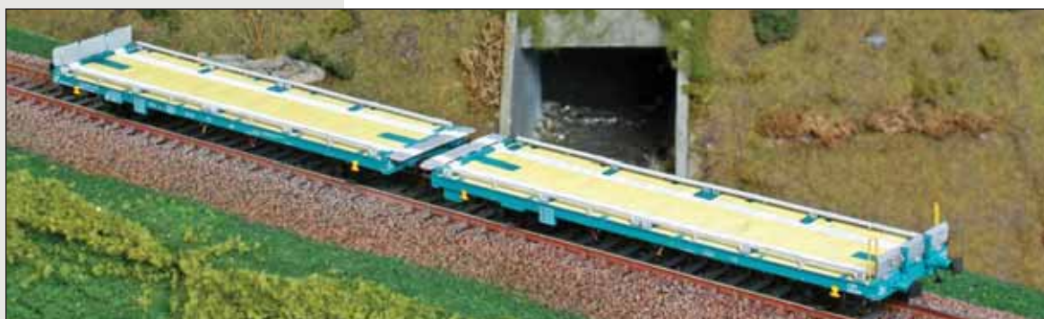
Carro pianale tipo Laadgrs per trasporto veicoli di grandi dimensioni, utilizzati in treni blocco su relazioni nazionali ed internazionali Type wagon for trucks transport, used in national and international trains. Flachwagen Typ Laadgrs für Lieferwagen und größere Fahrzeuge, in Ganzzügen national wie international eingesetzt.
