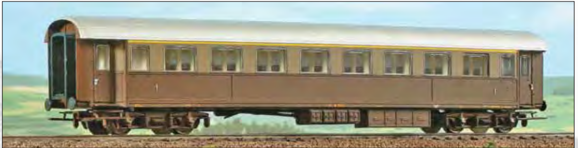
Carrozza FS di 1ª classe Tipo 1955R (Az 20500), livrea castano e Isabella di origine. Carrelli Tipo FS ABM con boccole a rulli. 1 st class Type 1955R (Az 20500) FS car. Type FS ABM bogies with roller bush, two tone brown livery. 1. Klasse Wagen Typ 1955R (Az 20500) der FS, Typ FS ABM Drehgestelle mit Rollenlager, zweitönige braune Ursprungslackierung.
