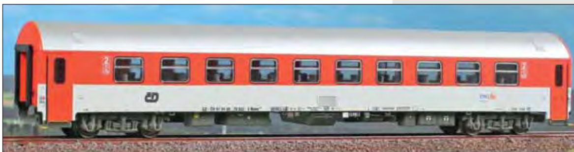
Carrozza ČD di 2ª classe Bpee con aria condizionata. ČD Bpee 2 nd class car with air conditioned system. ČD Bpee 2.Klasse Wagen, mit Klimaanlage.
