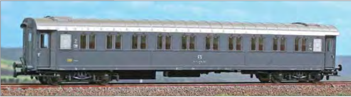
Carrozza di 2ª classe serie Bz 32000 degli anni '70, servizio interno, con porte risanate. Livrea grigio ardesia, carrelli FS 31. 2 nd class Type 1937 (Bz 32000) car of the FS for national services, with refurbished doors. Type FS 31 bogies, slate gray livery. 2. Klasse Wagen Typ 1937 der FS, schiefergraue Lackierung, erneuerte Türen, Typ 31 Drehgestelle, für interne Dienste.
