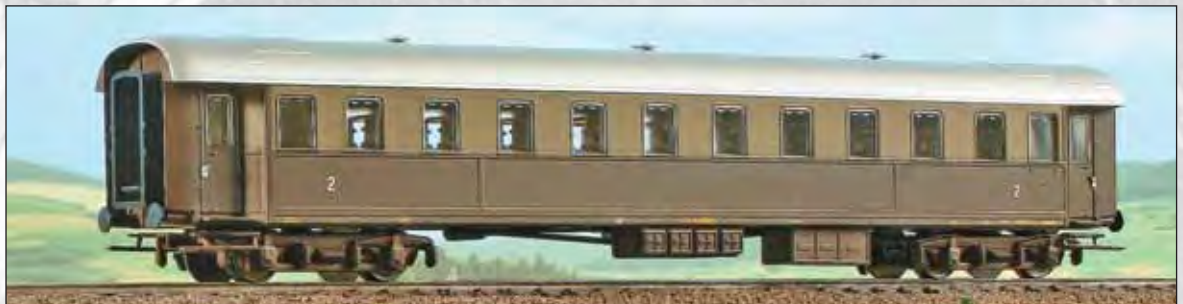
Carrozza FS di 2ª classe Tipo 1956R (Bz 30800) nella livrea castano di origine. Carrelli Tipo FS ABM. 2 nd class Type 1956R (Bz 30800) car of the FS. Type FS ABM bogies, original brown livery. 2. Klasse Wagen Typ 1956R (Bz 30800) der FS, Typ FS ABM Drehgestelle, braune Ursprungslackierung.
