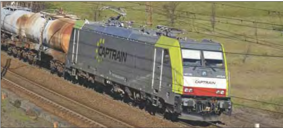
Locomotiva elettrica 483 032 Sangritana/TUA (Trasporto Unico Abruzzese) Direct Current locomotive 483 032 of the Italian railway company Ferroviaria Adriatico Sangritana/TUA. Elektrolokomotive 483 032 der Italienischen privaten Bahngesellschaft Ferroviaria Adriatica Sangritana.
