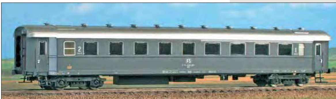
Carrozza a cuccette Tipo 1955 (AcBcz 64300-301) nella livrea grigio ardesia precedente la ristrutturazione del 1988. 1955 italian couchette car (AcBcz 64300-301) in the grey livery adopted before the 1988 refurbishing. 1./2. Klasse Liegewagen Typ 1955 (AcBcz 64300-301), in schiefergrauer Lackierung, vor der 1988 erfolgten Rekonstruktion.
