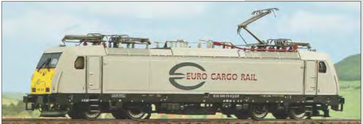
Locomotiva politemensione E 186 175 Euro Cargo Rail per i treni internazionali tra Belgio, Germania, Francia. Multi System E 186 175 Euro Cargo Rail used for goods trains between Belgium, Germany and France. E-lok E 186 175 der Euro Cargo Rail für internationale Güterzüge zwischen Belgien, Deutschland und Frankreich.
