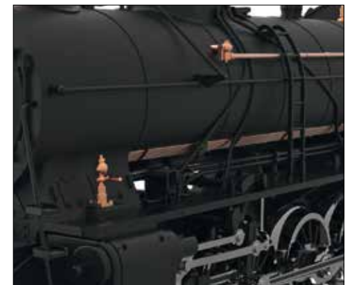
Besonders filigrane Metallkonstruktion. Freistehende Laternen und filigran angesetzte Aufstiegsleiter.
