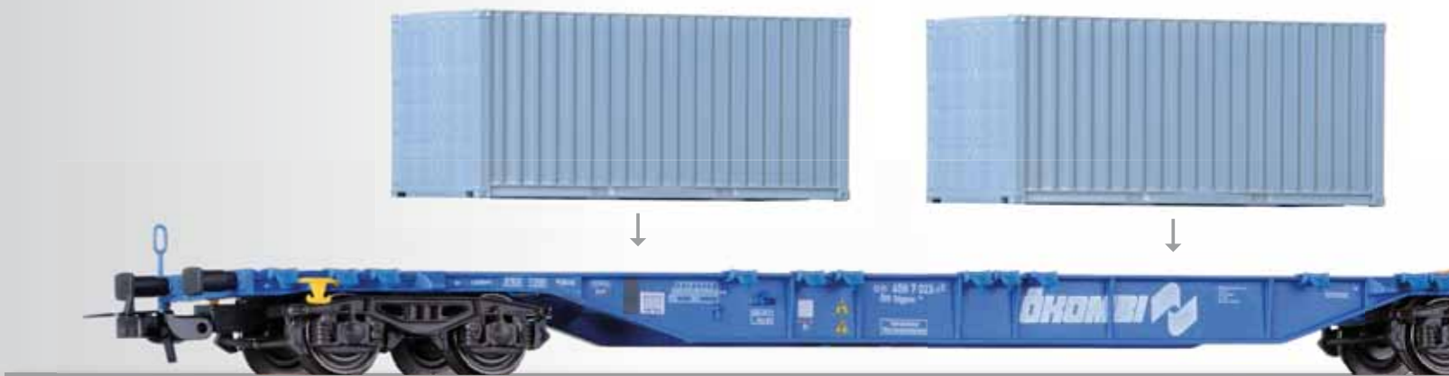
Doppeltragwagen Sdggmrss „Ökombi“ der ÖBB, beladen mit zwei 20" Container „P&O Nedlloyd“ und einem 40" Container „K Line“ / Container car Sdggmrs „Ökombi“ of the ÖBB with two 20" containers "P&O Nedlloyd" and one 40" container "K Line"
