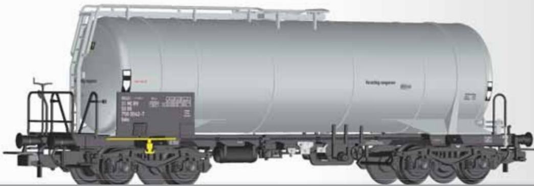
Kesselwagen Uahs der DR mit Heizeinrichtung Tank car Uahs of the DR with heating amatures
