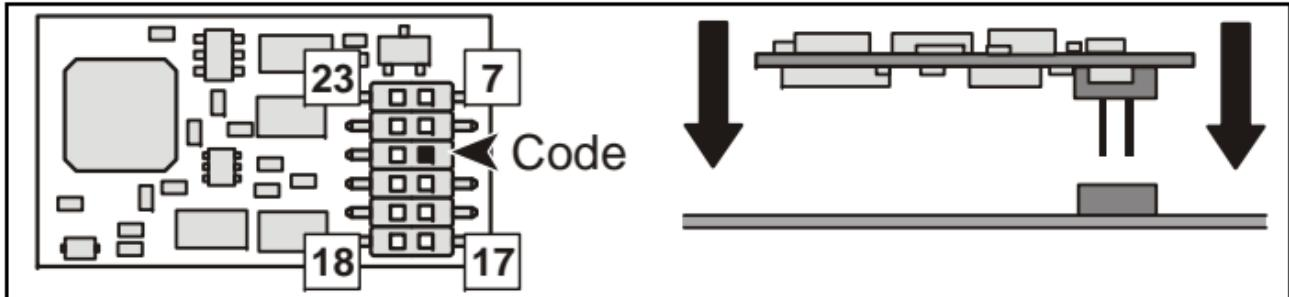
Abb. 1: SILVER+PluX12: 12-polige Schnittstelle /12-pole plug/12-pole Interface
