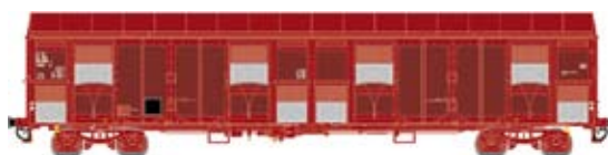
30 324 Gahss 0-16, rouge UIC, volets d'aération inox, 120km/h, Ep.IV UIC red, inox ventilating shutter, 120km/h Ep.IV
