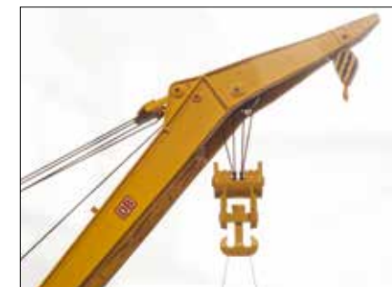
Kranhaken digital heb- und senkbar
