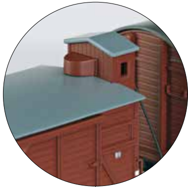
Sogenanntes Spar-Bremserhaus an 2 gedeckten Güterwagen
