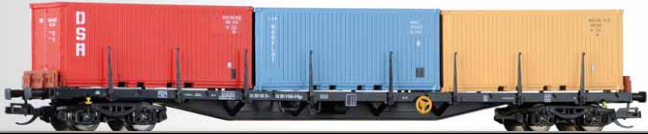
Containertragwagen Rgs 3910 der DR, beladen mit drei verschiedenen 20"-Containern Container car Rgs 3910 of the DR, loaded with three different 20"-containers
