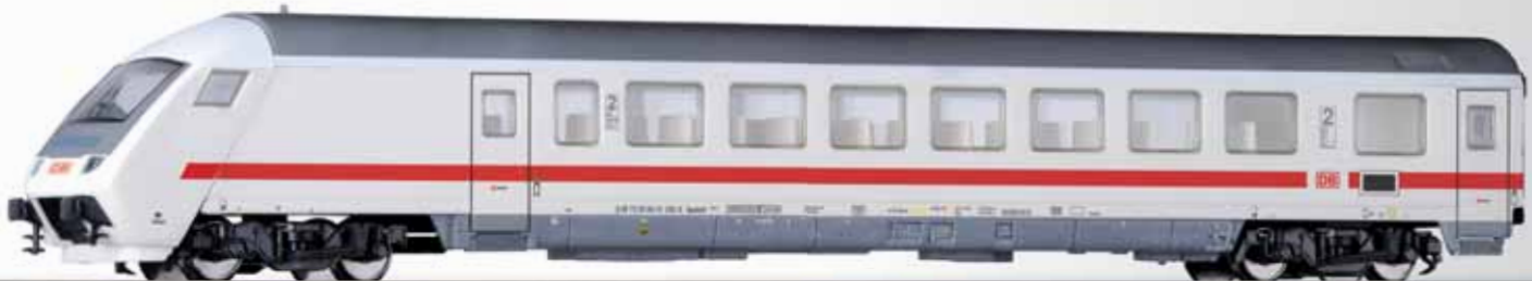
Steuerwagen Bpmbdzf 296.3 der DB AG in aktueller IC-Farbgebung Driving cap coach Bpmbdzf 296.3 of the DB AG in actual colouring
