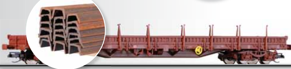
Niederbordwagen Res der DB AG, beladen mit Spundwänden Low side car Res of the DB AG, with cargo
