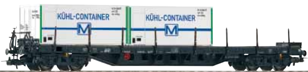
54836 Flachwagen Rgs3910 DR Ep. IV, beladen mit 2 Kühlcontainer
